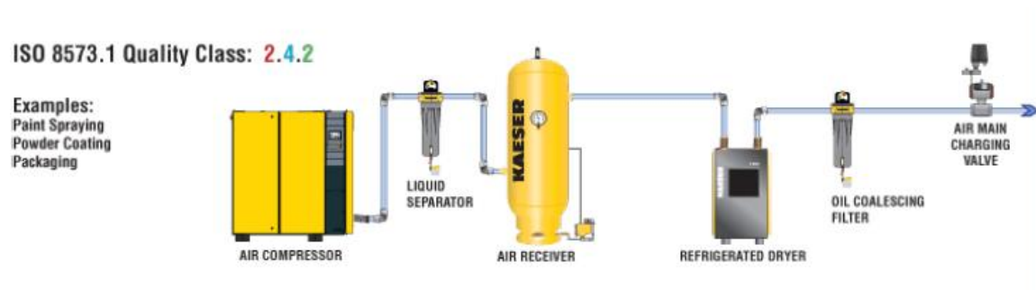
Figura 52. Arreglo recomendado para instalación neumática
