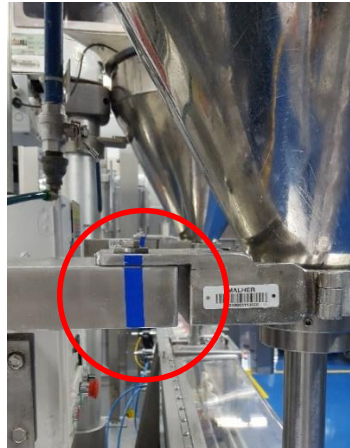
Figura 29. Ejemplo de diseño basado en Poka Yoke
