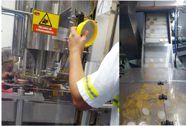
Figura 15. Inspección de liner en tapas
