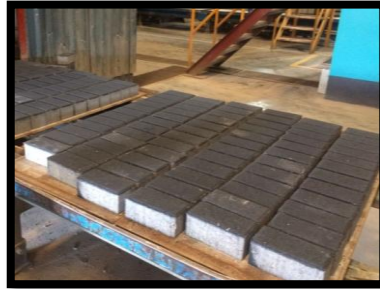
Figura 11. Adoquines sanos y libres de fisuras
