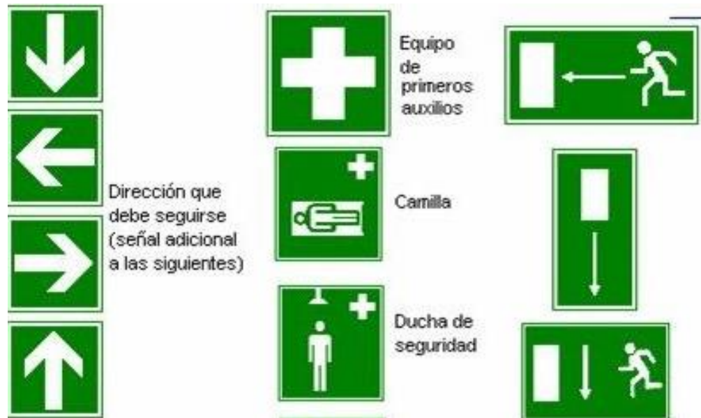
Figura 44. Señales de salvamento
