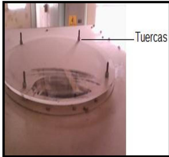
**Imagen No. 2.** Cuatro tuercas a retirar para quitar la ventana circular y poder entrar a realizar la limpieza y sanitización interior.
