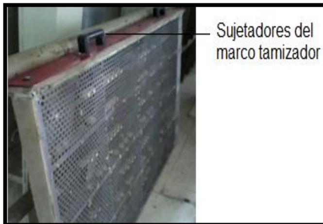
Figura 3. Se observa la superficie de uno de los marcos tamizadores.
