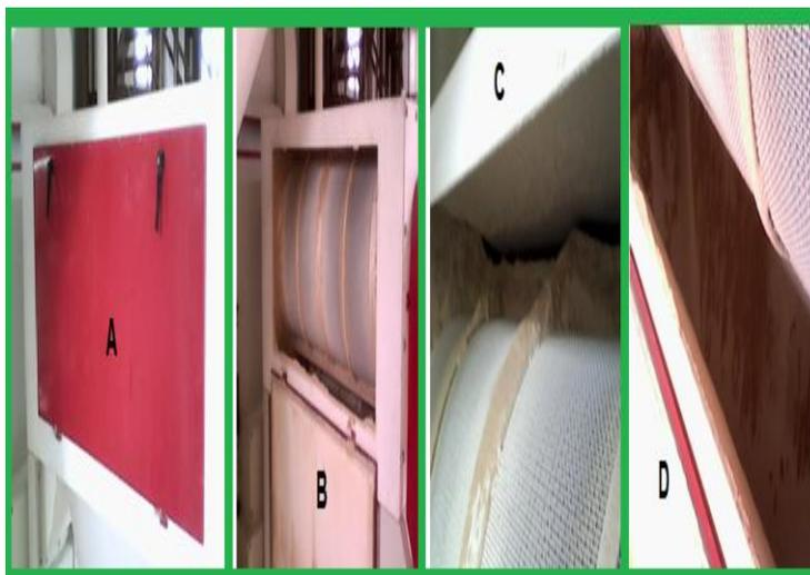
**Imagen No. 3.** Se observa la despuntadora intensiva ubicada en el segundo nivel del molino de trigo A) equipo sin desmontar y seguros tipo palanca B) tapadera abierta y malla a limpiar C) material de harina a remover D) tolva interior a limpiar y Sanitizar.
