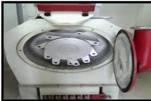
Imagen No. 2. Interior del molino de martillo
