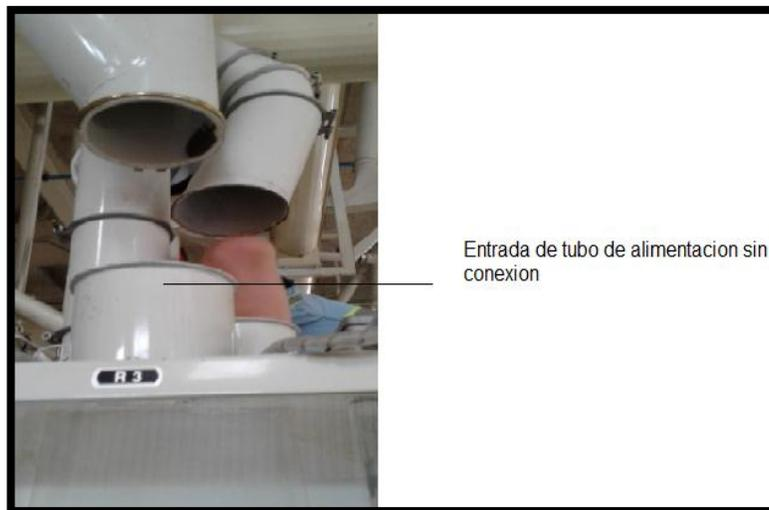
**Imagen No. 2.** Tubos de alimentación sin conexión
