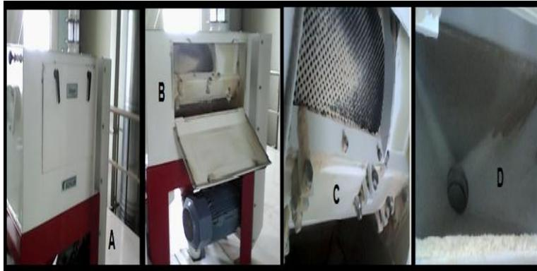
**Imagen No. 2.** Se observa la limpiadora horizontal intensiva ubicada en el quinto nivel del molino A) equipo sin desmontar B) tapadera abierta C) malla a limpiar y tornillos si se quiere desmontar D) tolva interior a limpiar y Sanitizar.
