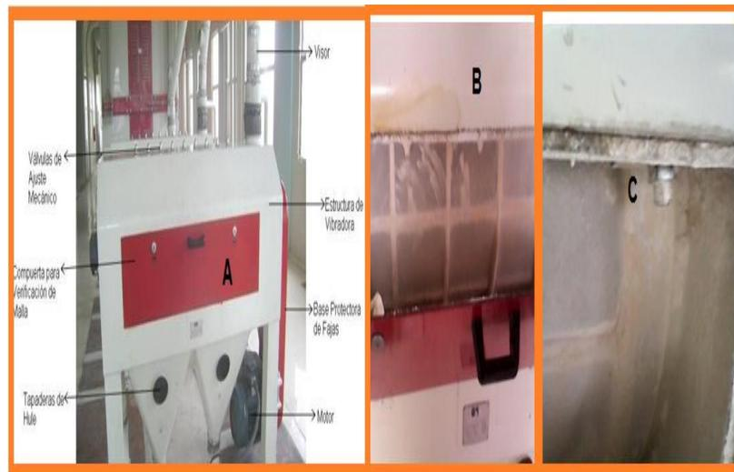
**Imagen No. 5.** Se observa una vibradora A) se describen sus diferentes partes B) malla a limpiar C) tornillos a quitar para quitar las mallas y limpiar y Sanitizar el interior.
