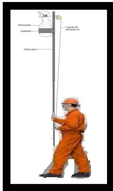
**Imagen No. 4.** Imagen del diseño del equipo de atomización para Sanitizar las paredes de los silos donde el operario para atomizar únicamente jalara de la cuerda de atomización.
