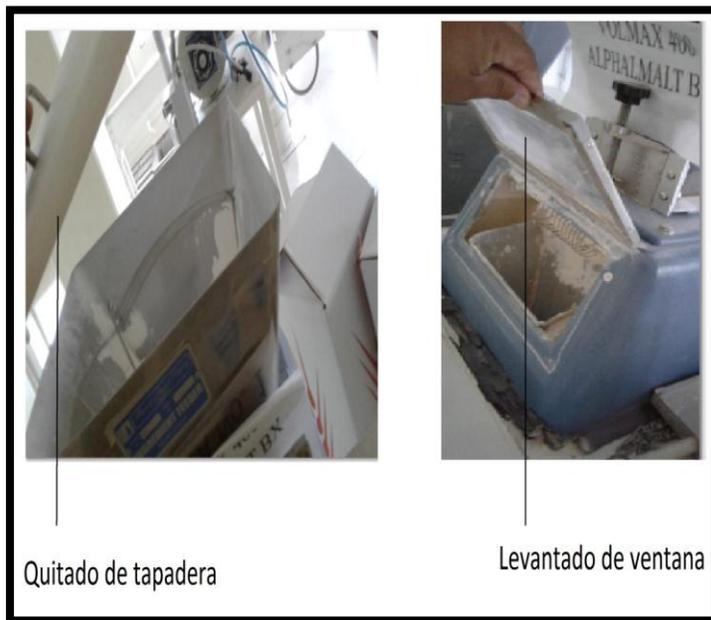
**Imagen No. 2.** Como se observa el desmontado de las tolvas no tiene ningún tipo de complejidad.
