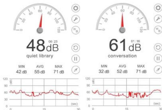
**Figura 28:** Estudio sonométrico, *de izquierda a derecha*, Promedio de la carretera CA-9, Durante el paso de transporte pesado. Elaborado con app Sound Meter, desarrollado por Smart Tools Co. (Guatemala, 2016).
