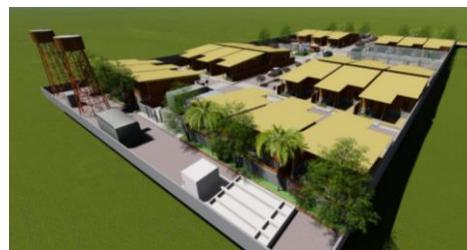
La permeabilidad del proyecto en el lado de la urbanización se garantiza al usar adoquín permeable en las calles para que permitan la filtración del agua al subsuelo.
