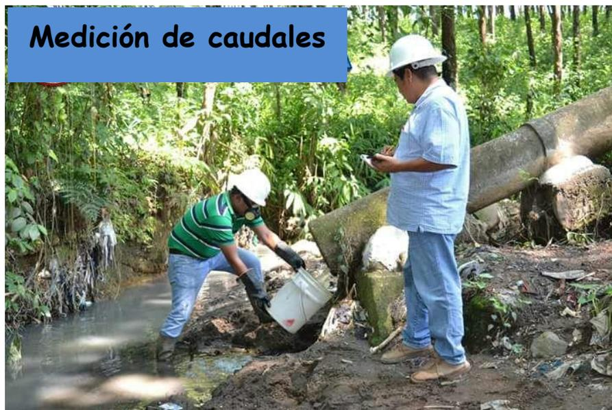
**Figura No. 5:** Medición de caudal de fosa séptica El Socorro No. 2
