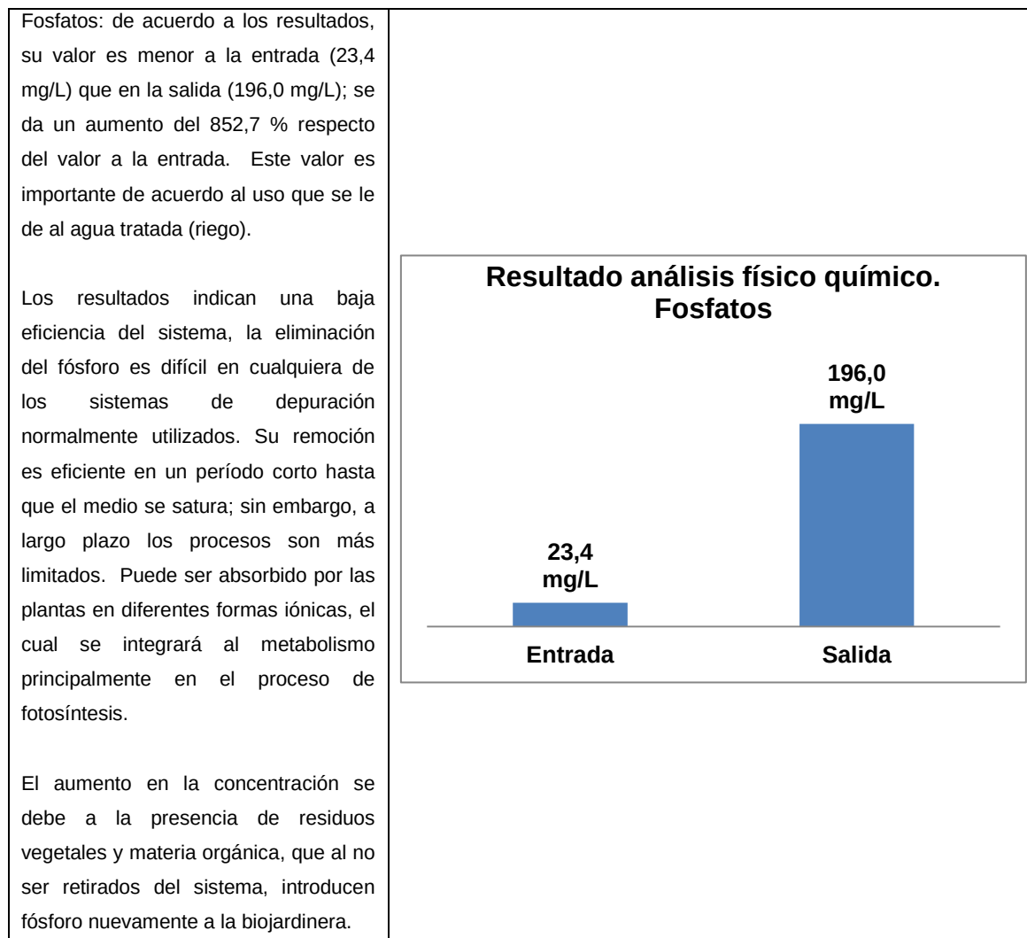
Figura 20. Evaluación del sistema de tratamiento (biojardinera). Comparación de resultados: fosfatos
