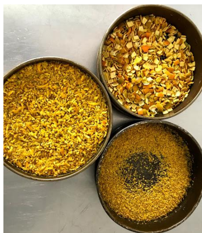
Figura 10. Variaciones de tamaño de partícula empleados para la extracción del aceite vegetal
