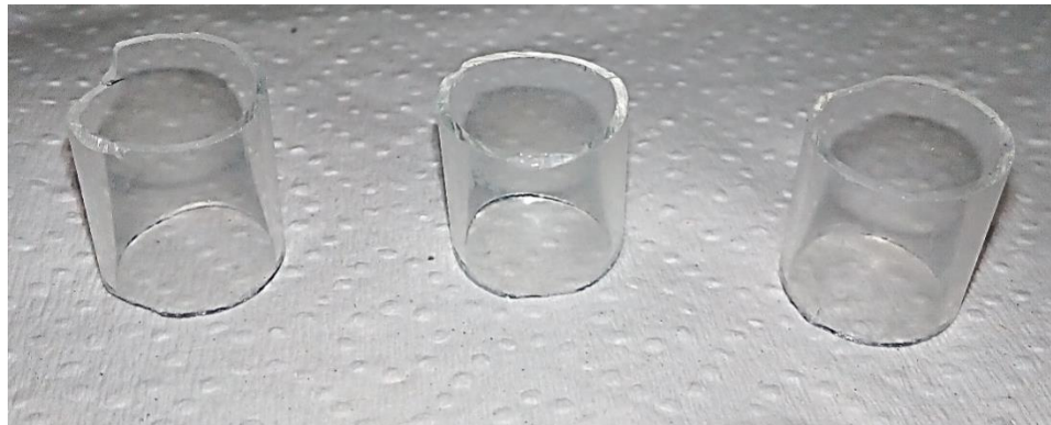
Figura 31. Empaques tipo anillos Raschig, vista frontal
