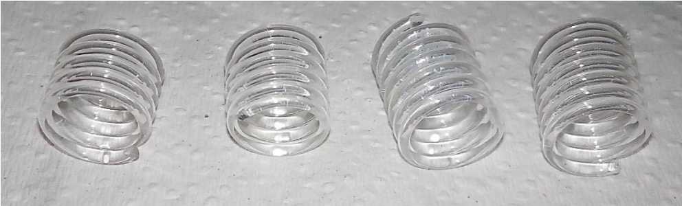
Figura 32. Empaques tipo anillos en espiral, vista superior
