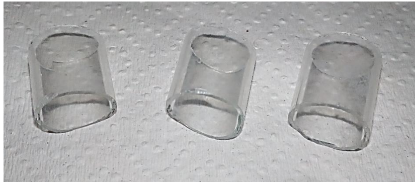
Figura 30. Empaques tipo anillos Raschig, vista superior
