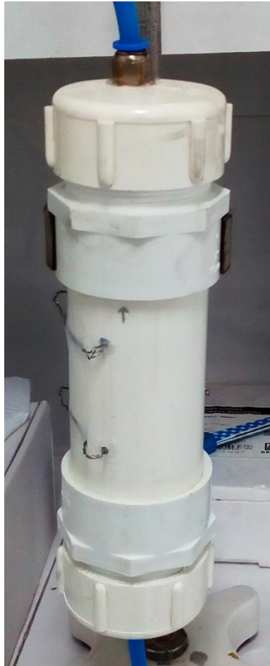
Figura 14. Reactor electrolítico continuo vista frontal
