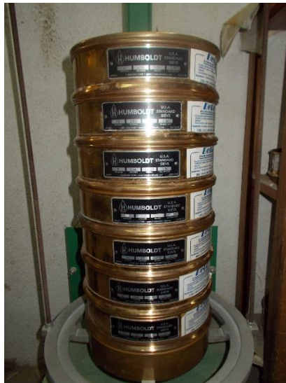
Figura 38. Tamizadora motorizada Humboldt ASTM E11 7 tamices
