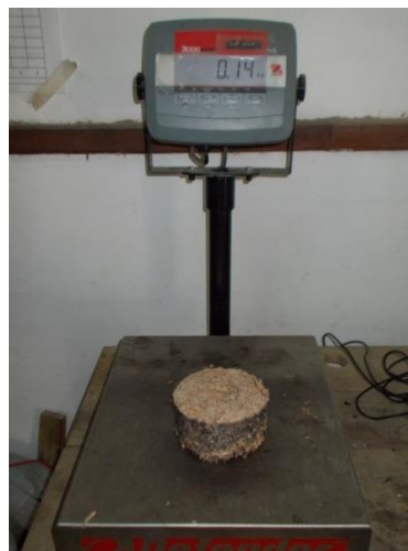
Figura 30. Peso exacto de briqueta seca en kilogramos
