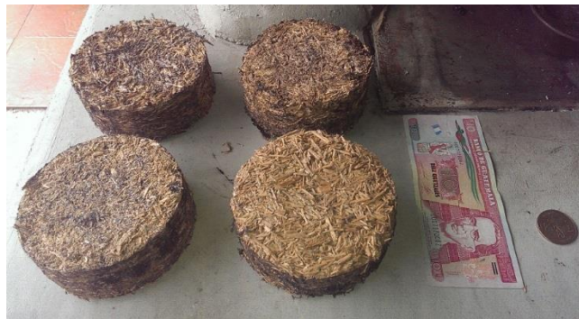
Figura 15. Briquetas elaboradas en laboratorio con referencia de billete y moneda nacional
