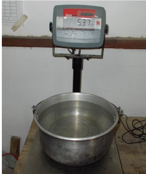
Figura 31. Olla de laboratorio con agua 5 kg y tara 0.37 kg
