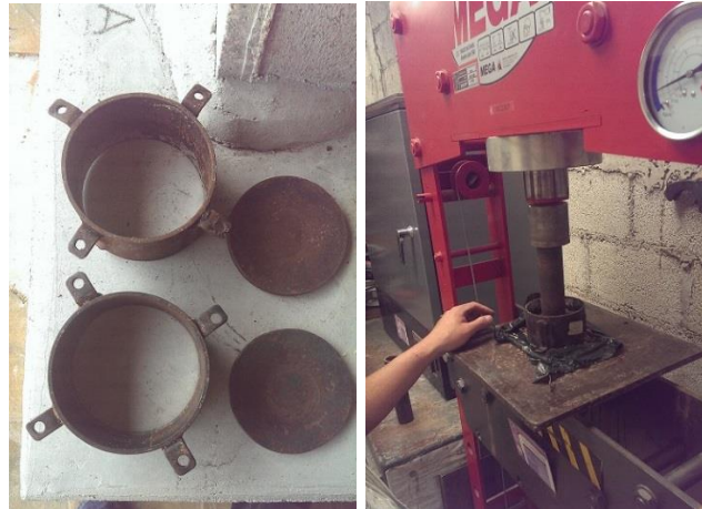
Figura 12. Probetas de acero y prensa hidráulica de 50 toneladas Kg/cm 2
