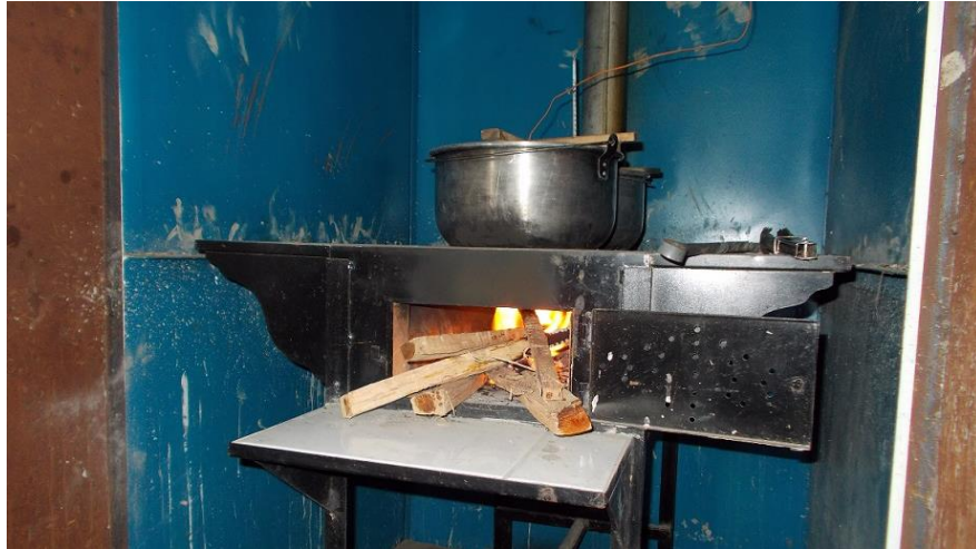
Figura 33. Prueba WBT en frío con leña de encino y ollas con agua
