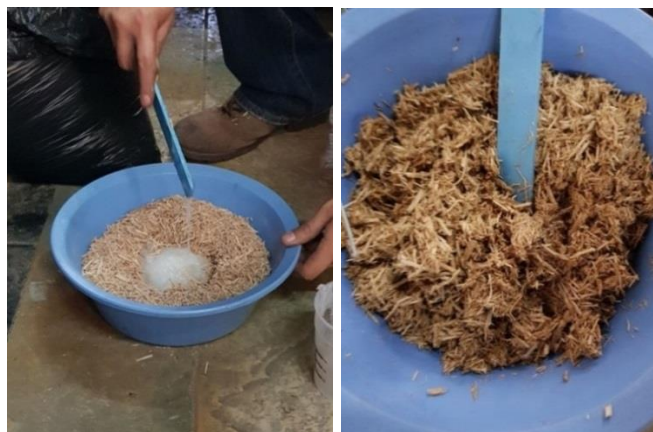
Figura 11. Proceso de mezcla de aserrín de eucalipto con aglutinante
