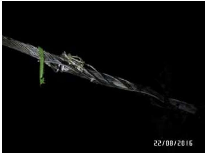
Figura 36. Discontinuidades por detectar en el conductor
