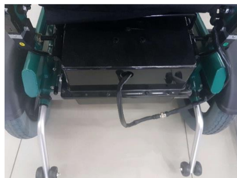
Figura 45. Compartimiento de baterías
