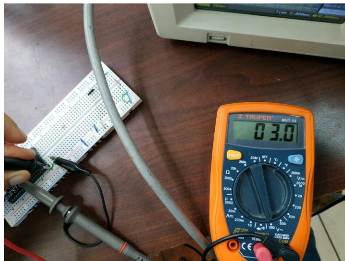
Figura 27. Voltaje CA medido en el GPIO25
