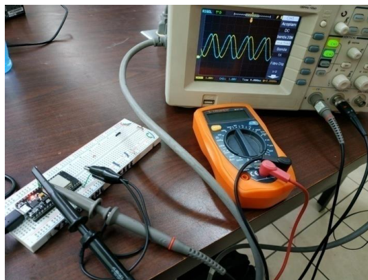
Figura 33. Señales de salida traspuestas generadas por los DAC GPIO25 y GPIO26
