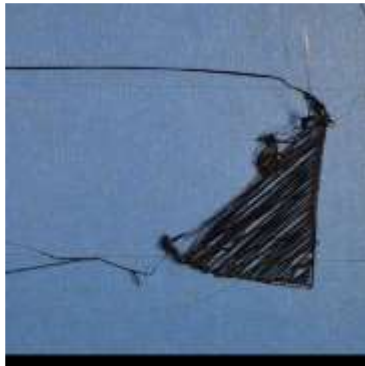
Figura 41. Impresión no adhiere a la base
