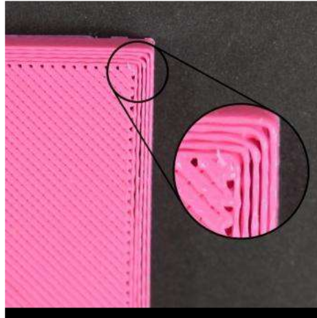
Figura 42. No se extruye suficiente plástico
