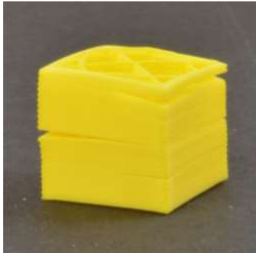
Figura 45. Separación y división de capas
