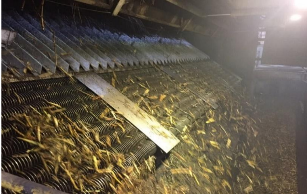
Figura 11. Mesa de Lavado en seco de la caña de azúcar
