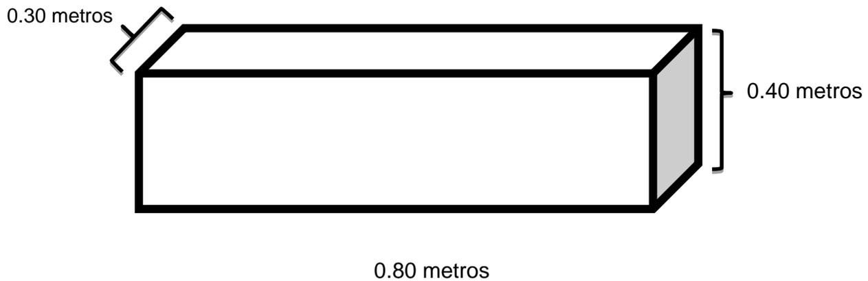
**Figura 9:** Molde para la fabricación de la caja de madera.
