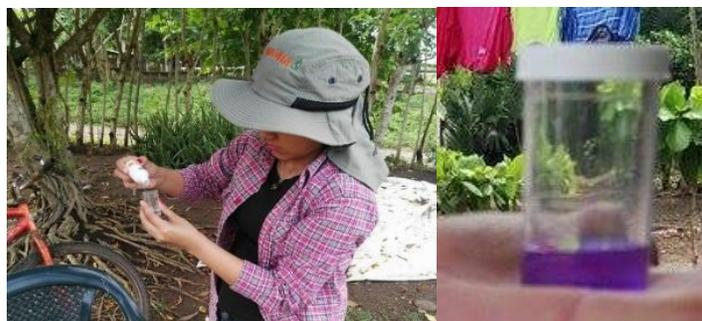
**Figura 16:** Muestra de la aplicación de BROMOPHENOL a la muestra de agua.
