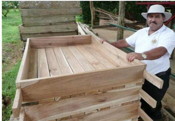
**Figura 7.** Fermentadora y secadora tipo Rohan con dimensiones de 1.20m\*0.90m\* 012m
