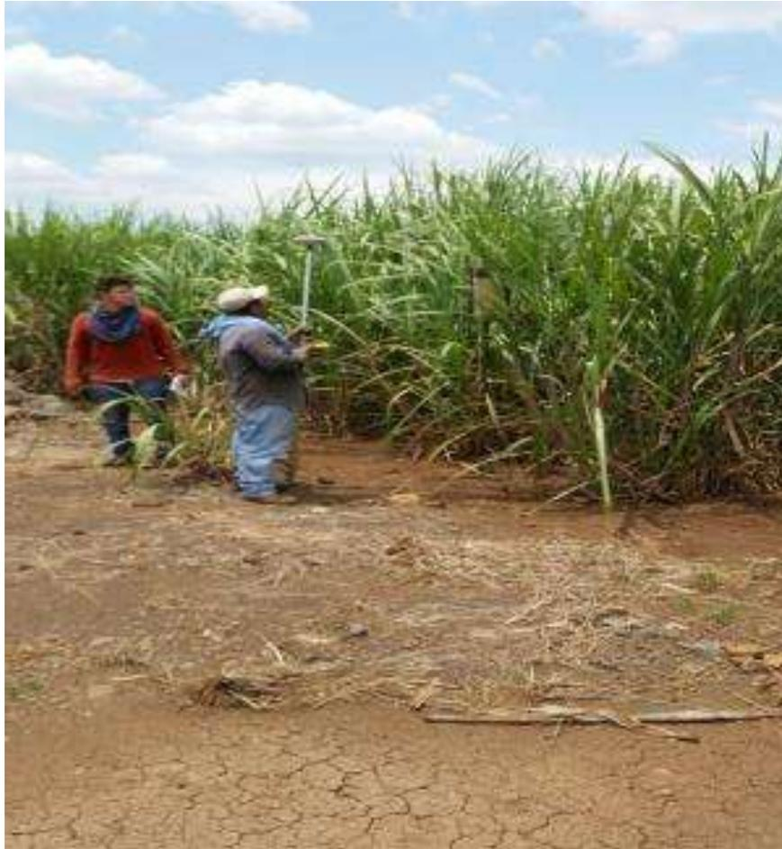
Imagen 7. Toma de puntos georeferenciales con GPS marca Garmin.
