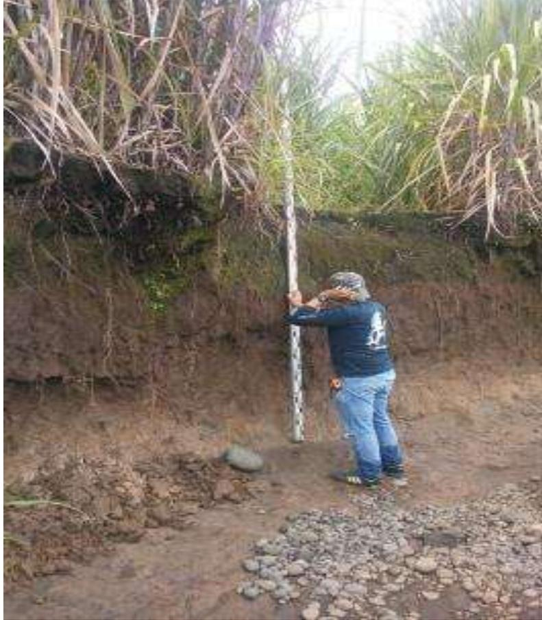
Imagen 6. Medición de canales de riego del ingenio Tululá S.A con estadal y cinta métrica.
