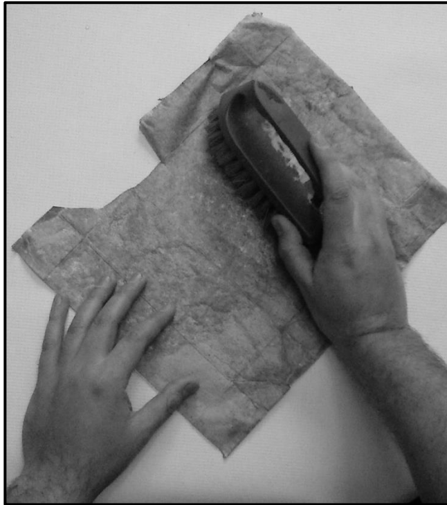
Figura 40. Separación de residuos de papel en polialuminio
