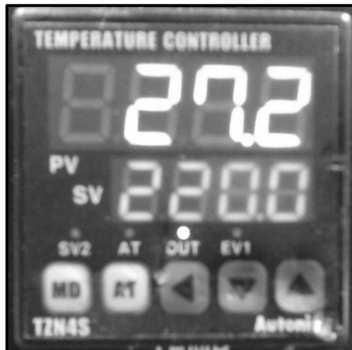
Figura 8. Control de temperatura programable del horno
