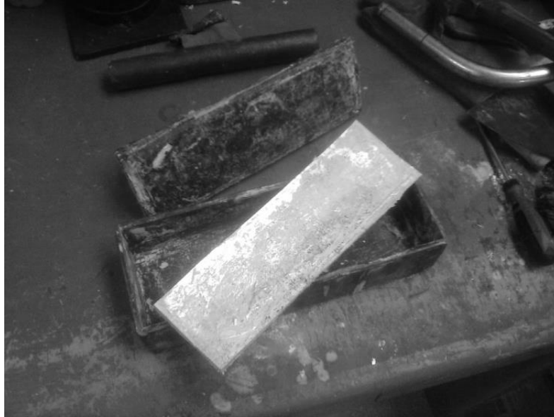
Figura 46. Panel de polialuminio elaborado
