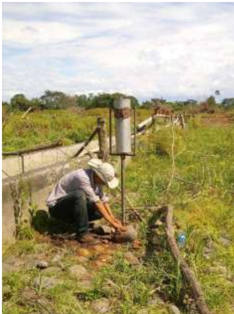
Figura No.15 Implementación de pluviómetro en Finca Buena Vista Capuano
