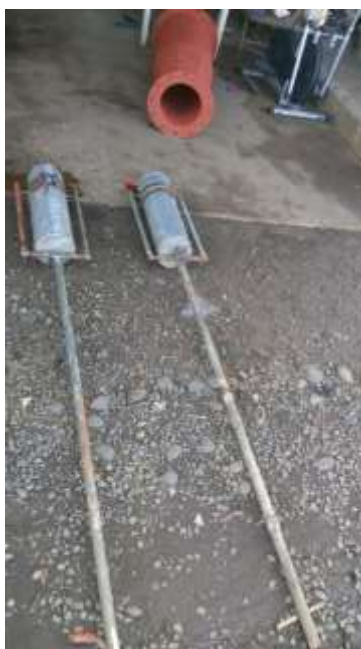
Figura No. 14: Pluviómetros listos para su instalacion
