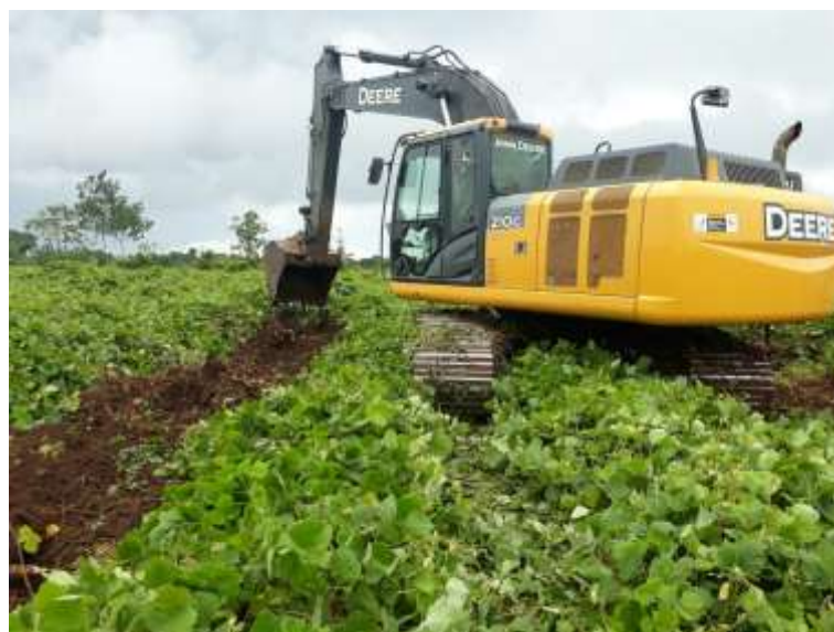
Figura No. 12 Máquina Excavadora Jonh Deere 210 G en labor de descombro de tocones de hule
