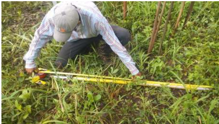
Figura No.11: Calibración de bastones con metro
