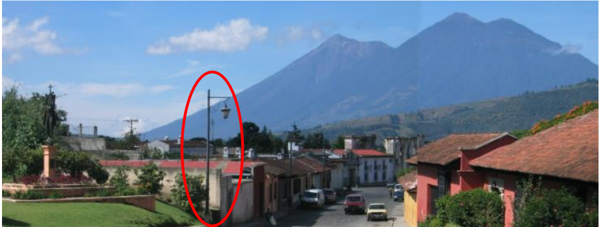
Figura 20. Antena de radiofrecuencia mimetizada como farol
