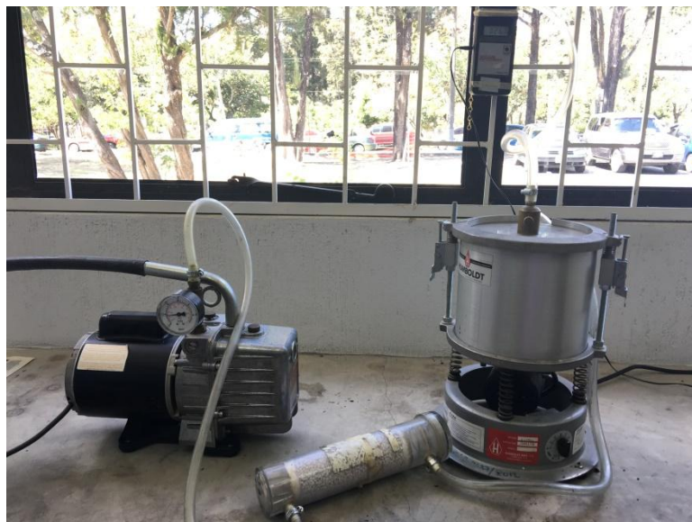
Figura 11. Bomba de vacío, picnómetro para vacío y dispositivo de agitación. Dispositivo para atrapar el vapor de agua y manómetro de presión residual
