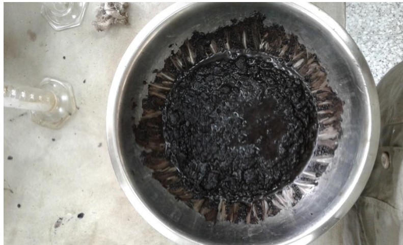
Figura 17. Preparación de la emulsión asfáltica
