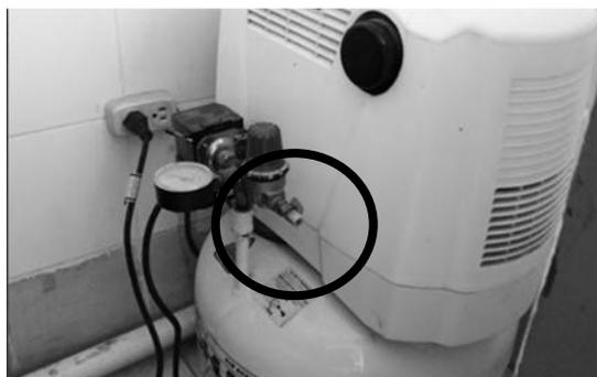
Cuando se presionaba el reóstato, se escuchaba una fuga de aire bastante fuerte en la caja de controles de la unidad. Cuando se desarmó, la manguera de entrada de aire a la turbina estaba rajada, lo que restaba fuerza a la misma. Se observaba que las mangueras de baja velocidad estaban deterioradas, se procedió a cambiarlas, junto con las mangueras de entrada de agua.
