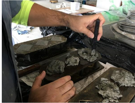
Figura 17. Colocación de mezclas de mortero
