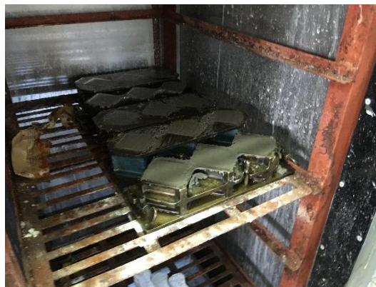
Figura 18. Fundición de cubos de mortero
