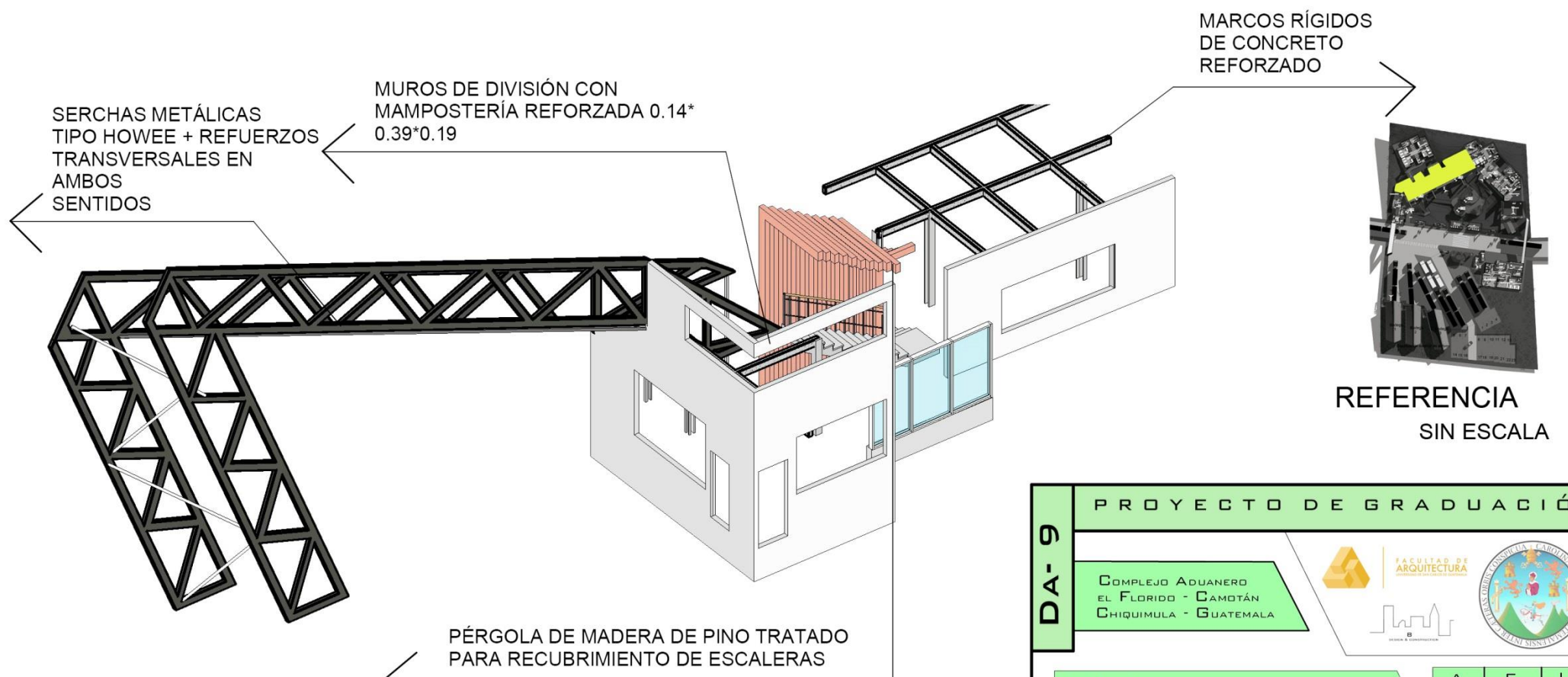
SECCIÓN 2-2 ESTRUCTURAL DE GARITA, BANCO Y RECEPCIÓN ESCALA 1: 100
