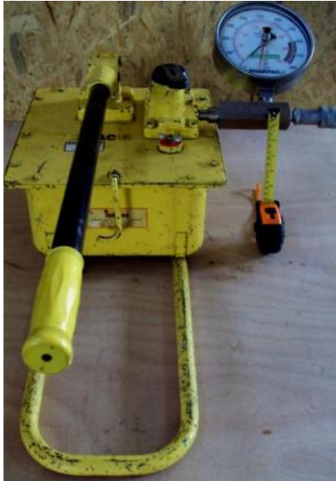
Figura 35. Bomba hidráulica P- 462
