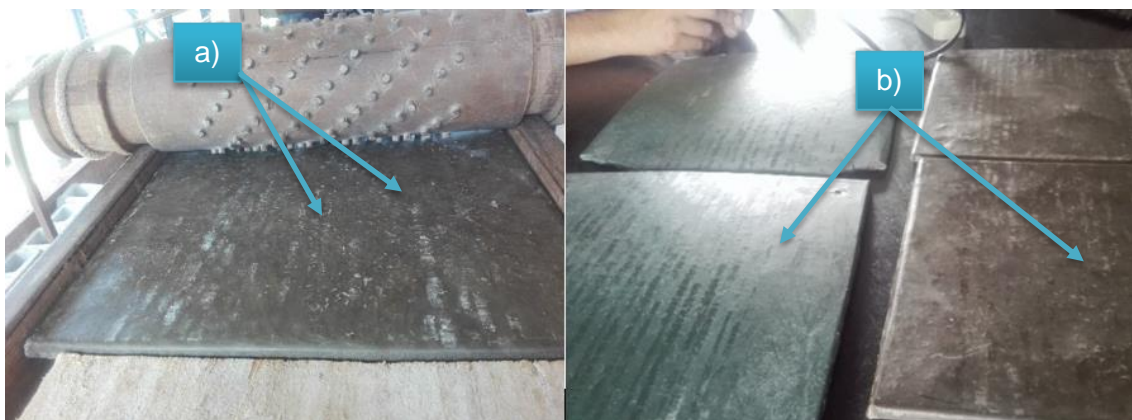
Figura 73. Ensayo de desgaste
