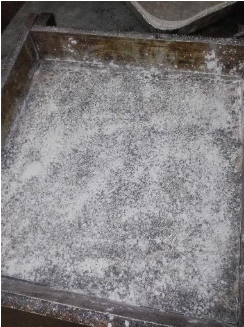
Figura 62. Polipropileno con estearato de zinc
