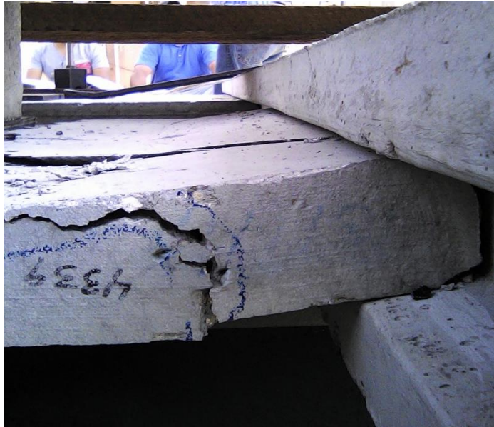
Figura 134. Pestaña del poste casi intacta posterior al trabajo ejercido por las placas
