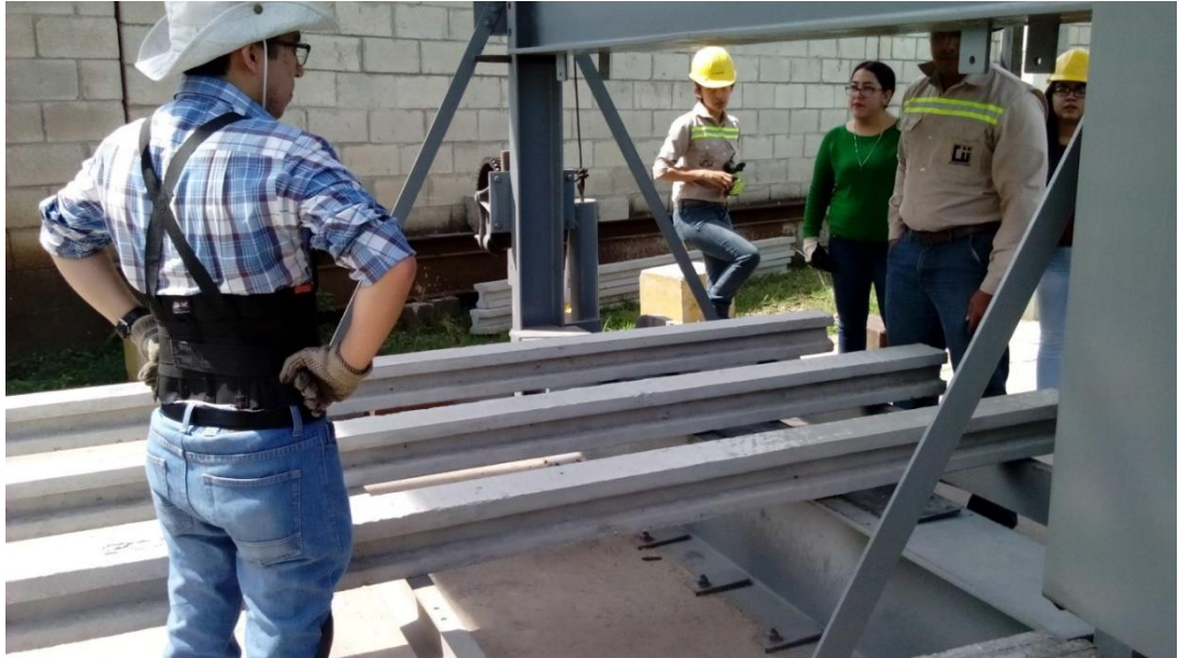
Figura 7. Colocación de postes sobre el marco de carga, para simular el empotramiento de los mismos
