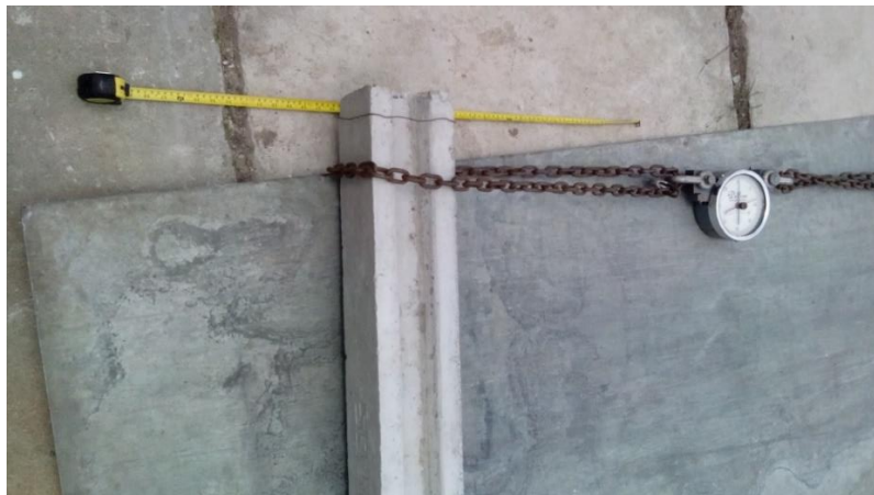
Figura 117. Lectura de deriva producida por la flexión y uso del dinamómetro para la lectura de carga (lb)
