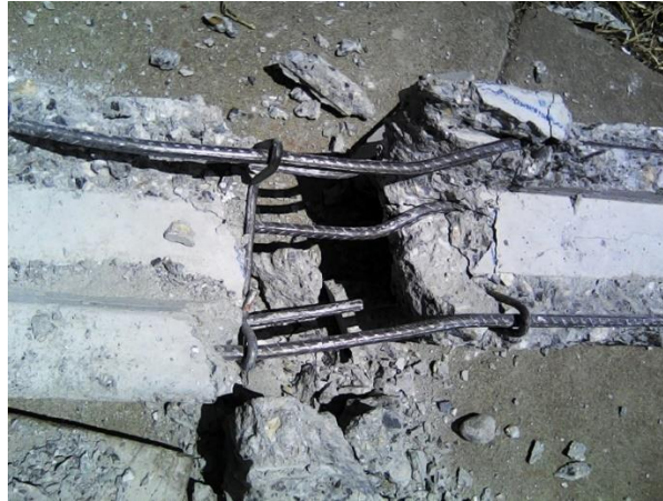
Figura 141. Análisis del acero longitudinal y transversal del poste
