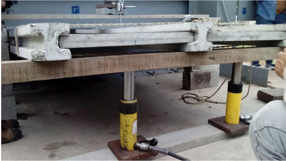
Figura 125. Deflexión máxima producida por el empuje horizontal
