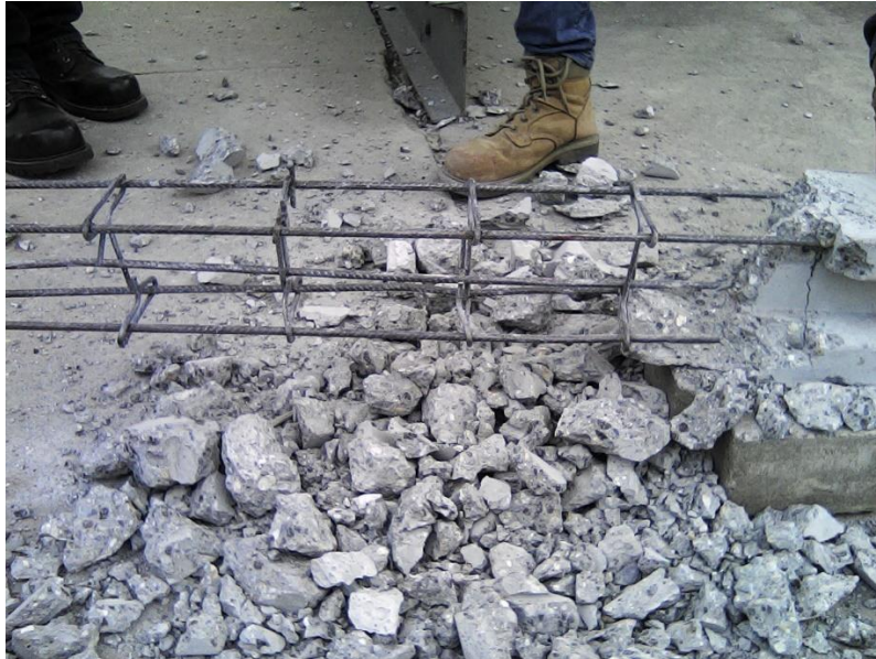
Figura 127. Análisis del refuerzo longitudinal del poste, posterior al ensayo del sistema
