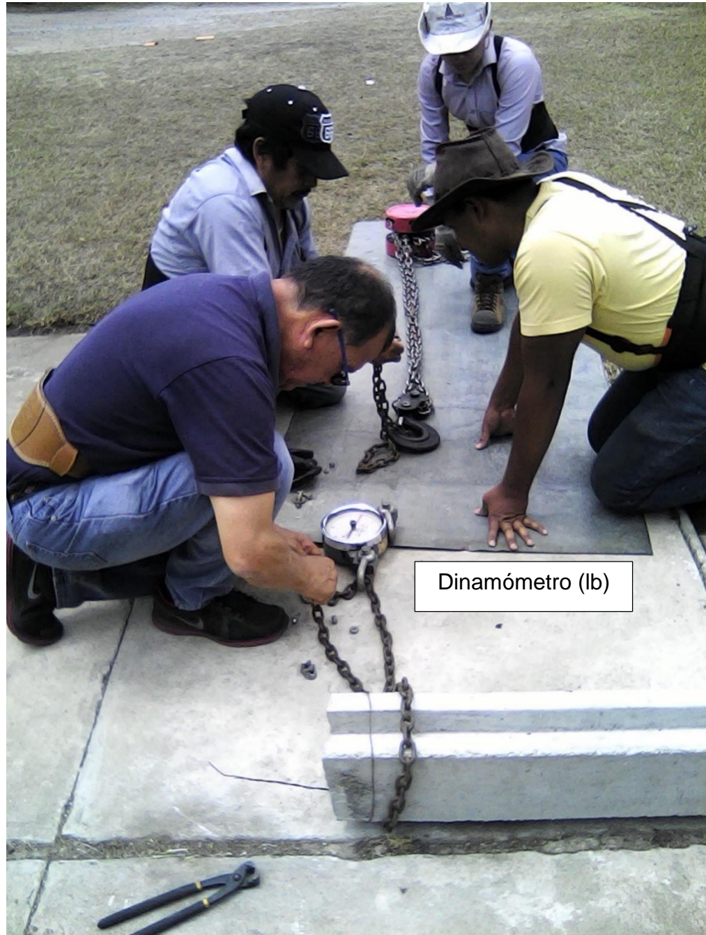
Figura 118. Preparación de ensayo a flexión de postes
