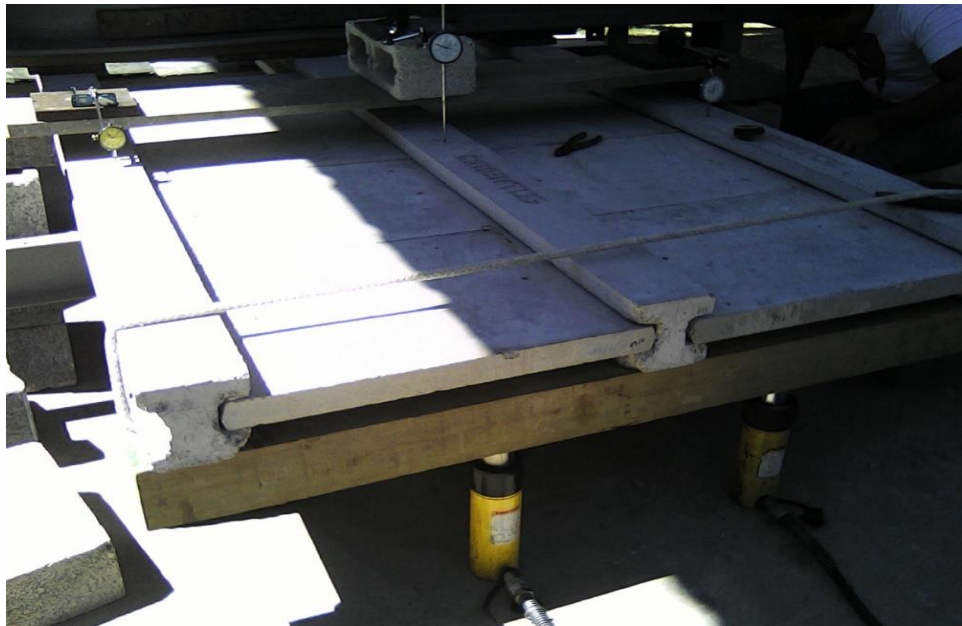
Figura 111. Ubicación de gatos hidráulicos con capacidad de 25 ton y deformímetros en cada poste
