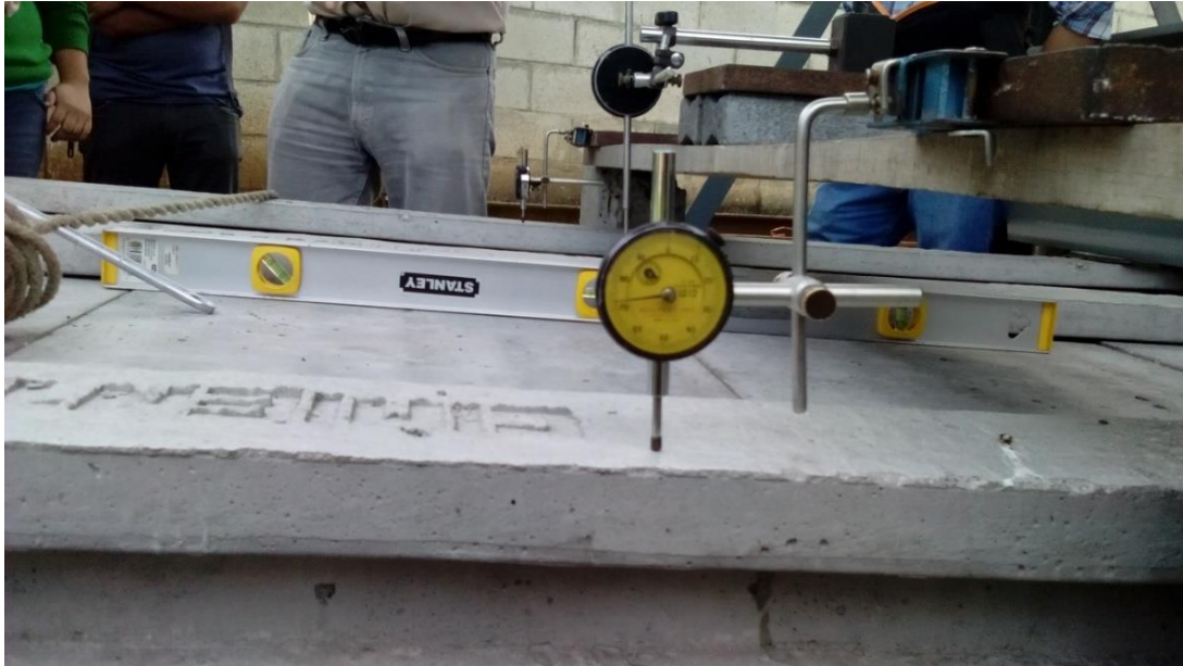
Figura 112. Lectura de deformaciones a L/2 de la altura del poste por cada uno respectivamente
