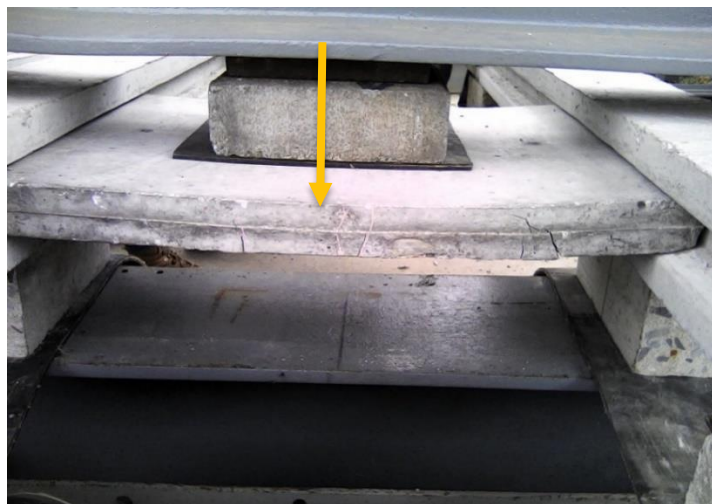
Figura 115. Análisis del comportamiento de las placas y el efecto que produce sobre la pestaña del poste que las contiene
