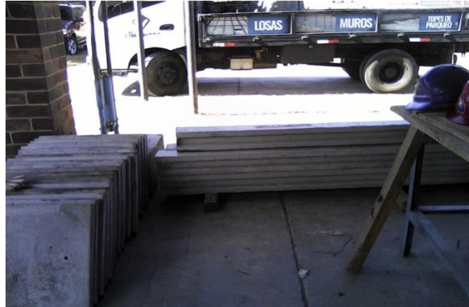
Figura 5. Elementos prefabricados – placas y postes que conformarán el sistema de ensayo
