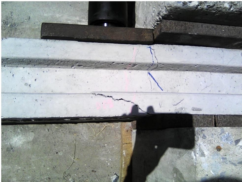
Figura 138. Agrietamiento y aplicación de carga cortante
