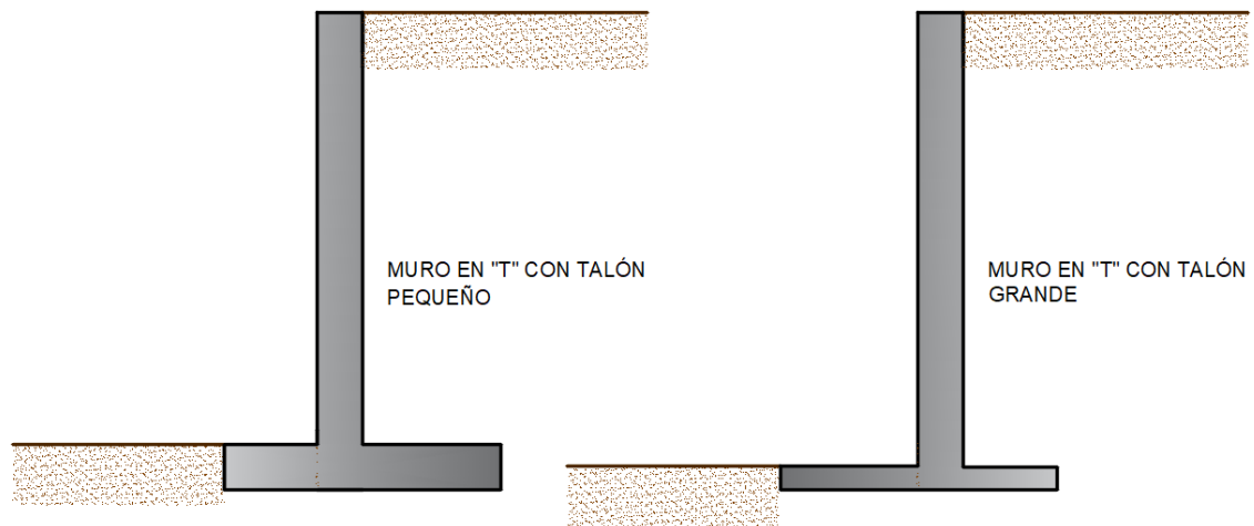
Figura 86. Muro en T, de gran talón y muro en T; con talón pequeño
