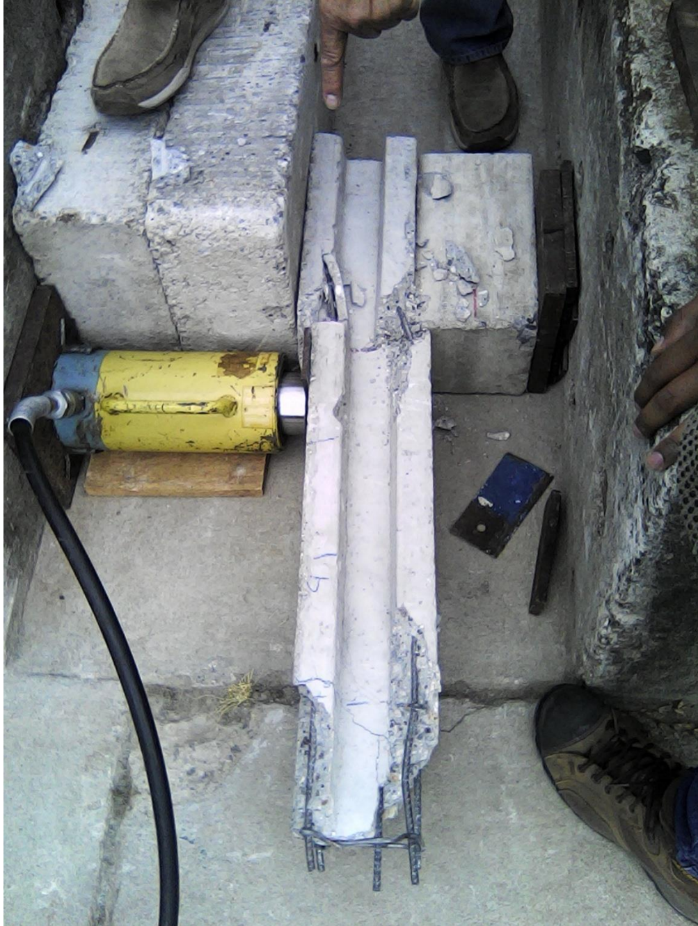
Figura 140. Colapso del elemento por aplicación de esfuerzo cortante
