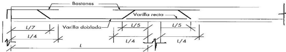
Figura 62. Dimensiones de tensiones y bastones
