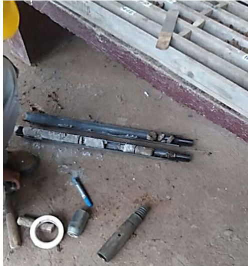
Figura 20. Extracción de muestras de cuchara SPT
