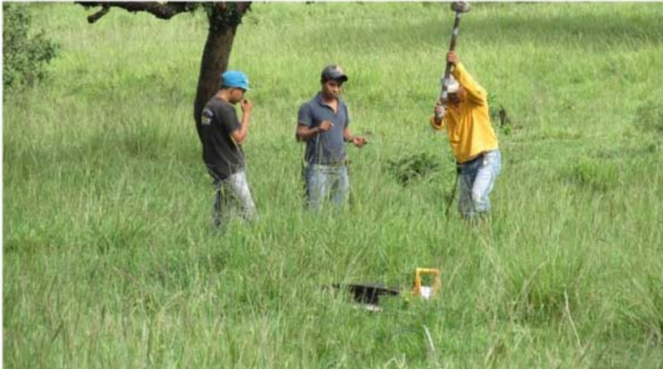
Figura 25. Golpeo para provocar ondas sísmicas
