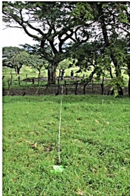
Figura 24. Vista del tendido de geófonos
