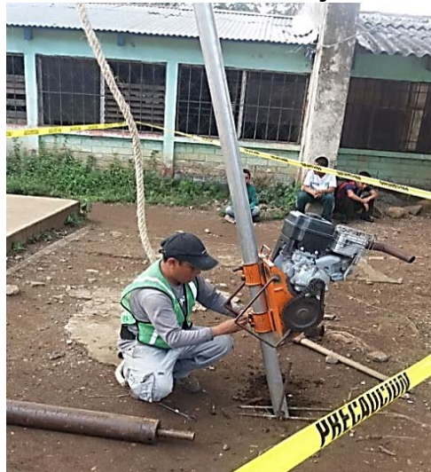
Figura 19. Proceso de ensamblaje de motor para SPT
