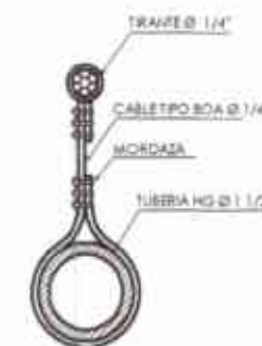
DETALLE DE SUSPENSION DE TUBO
