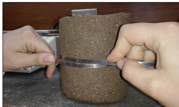
Figura 49. Medición de dimensiones de las probetas
