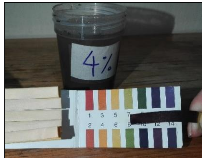
Figura 38. Determinación de pH de muestra de suelo con 4 % de cal
