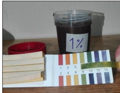
Figura 35. Determinación de pH de muestra de suelo con 1 % de cal
