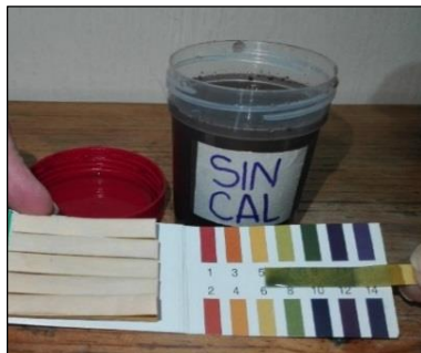
Figura 34. Determinación de pH de muestra de suelo sin cal
