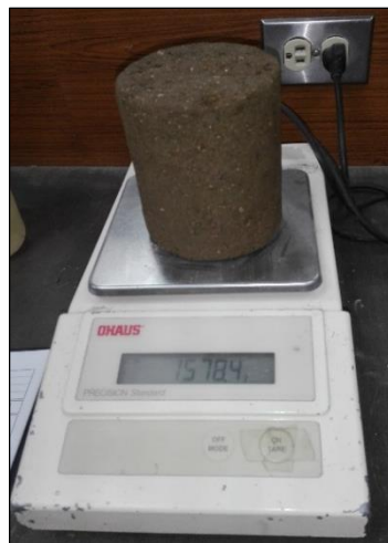
Figura 48. Toma de peso de probeta
