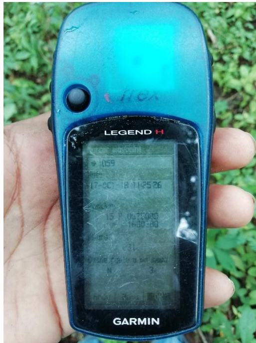
Figura 11: (G.P.S) utilizado para la toma de datos topográficos.
