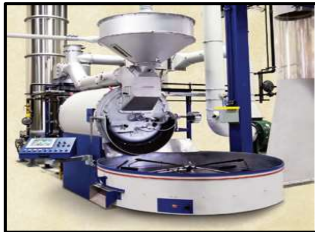
Figura 14. Equipo para el tueste de café a escala industrial
