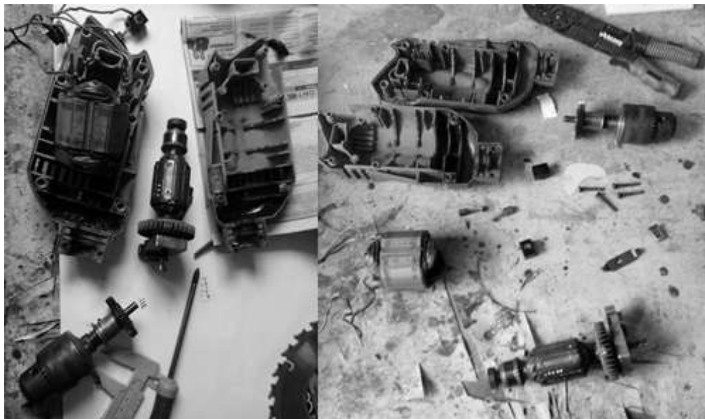
Figura 55. Estado deteriorado en el que se encontró el taladro
