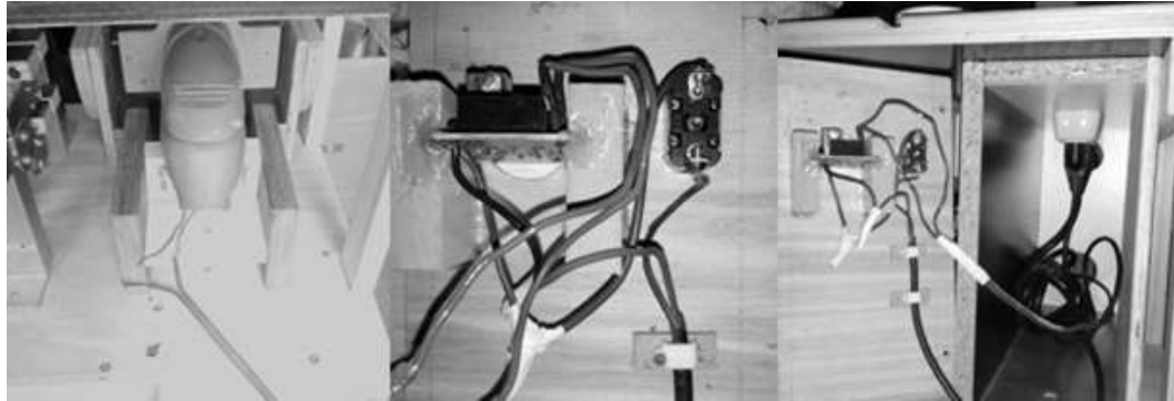
Figura 57. Conexiones eléctricas del router y lijadora
