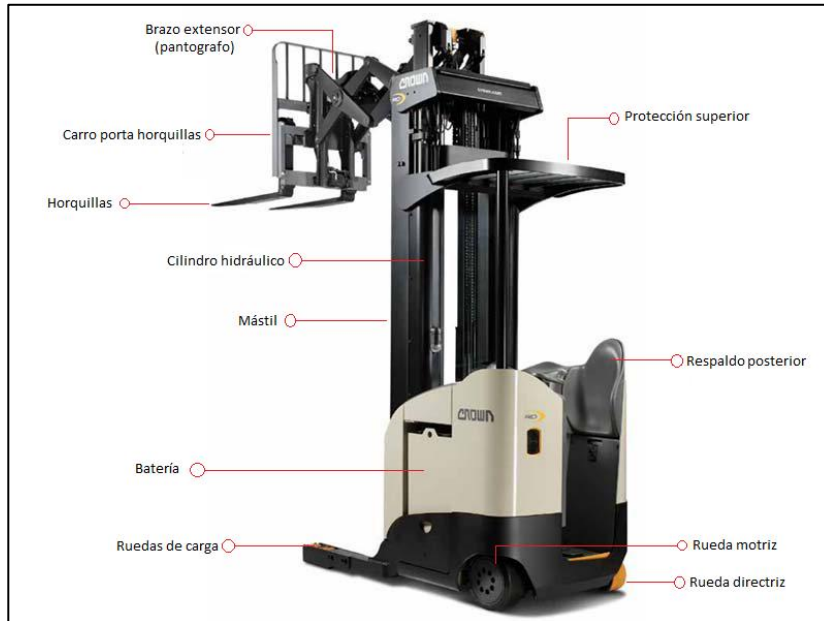
Figura 6. Montacargas eléctrico para pasillo angosto
