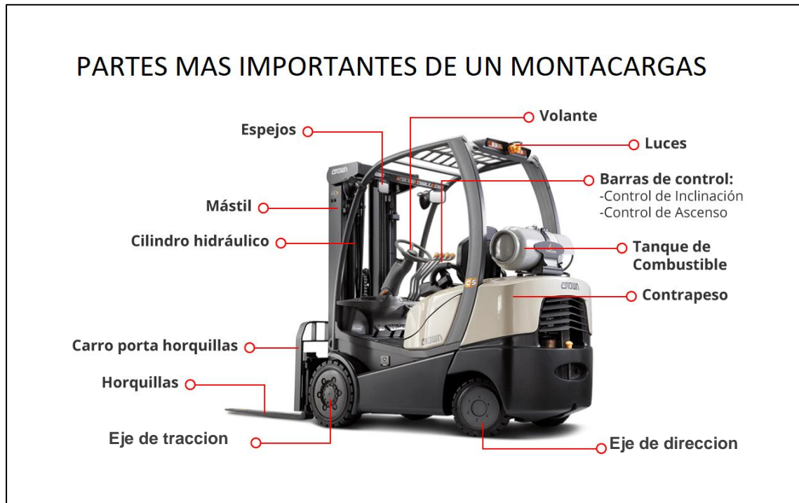
Figura 13. Partes del montacargas
