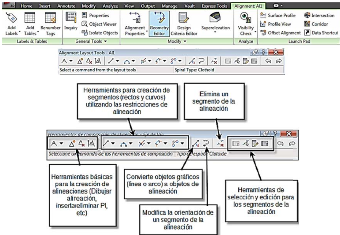
Figura 85. Barra de herramientas para edición de alineaciones
