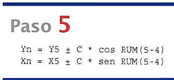
Figura 7. Imagen que describe el paso 5, del procedimiento de separar polígonos a base de un punto del perímetro
