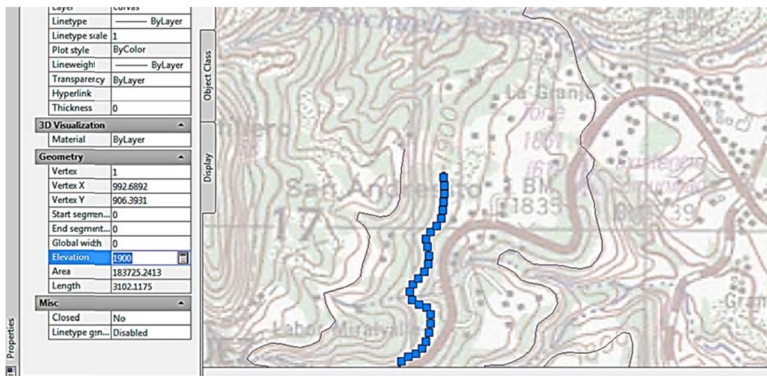
Figura 51. Asignación de elevación a las curvas de nivel
