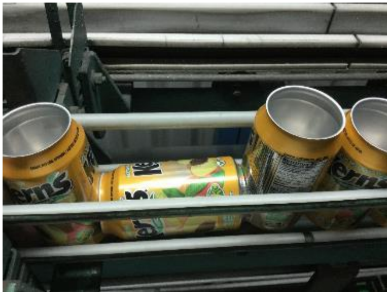
Figura 8. Envase caído en cable aéreo
