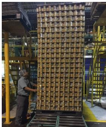
Figura 5. Operador alineando pallet en carrilera
