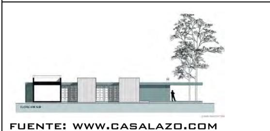
LAS FORMAS DE LOS TECHOS PUEDEN PLANTEARSE PLANOS Y CONFORMADOS CON MATERIALES QUE ME LOGREN ELIMINAR LO MAYOR POSIBLE DE RADIACIÓN SOLAR.
