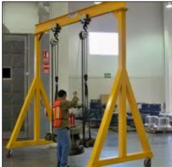
Figura 8. Puente grúas móvil
