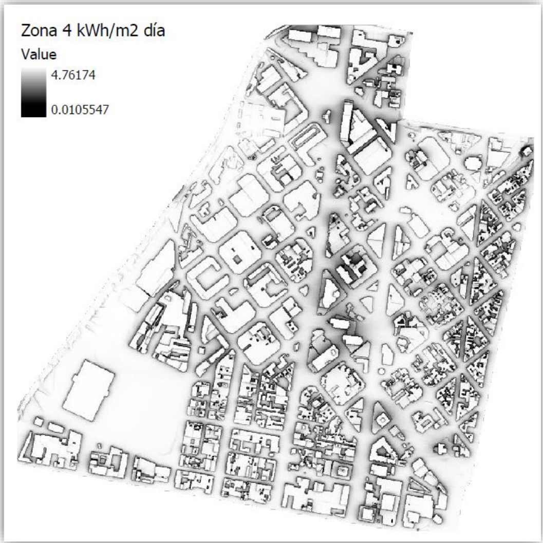
Figura 35. Ráster con valor de radiación solar global de la zona 4
