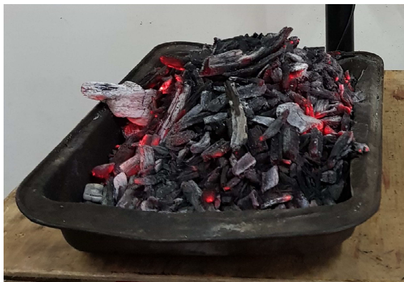
Figura 19. Carbón generado por la combustión de la hoja de palma de coco
