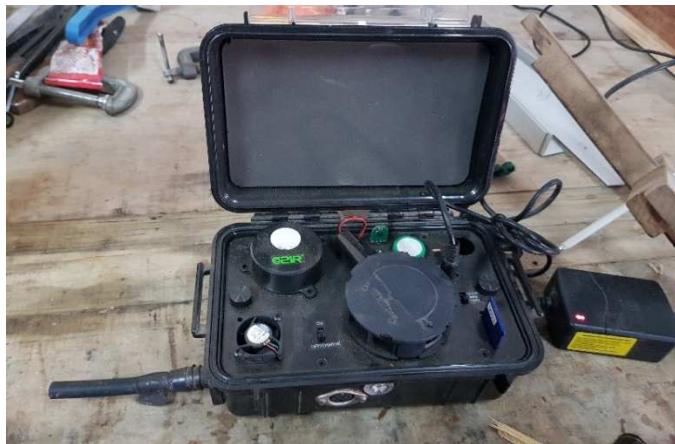
Figura 10. Medidor de contaminación del aire interior (IAP)
