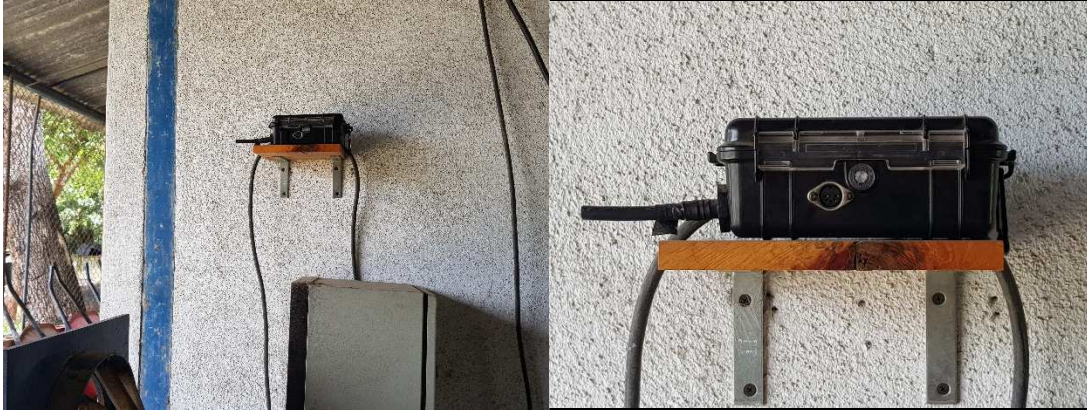
Figura 22. Calibración del instrumento utilizado para la medición de emisiones de CO y PM 2,5
