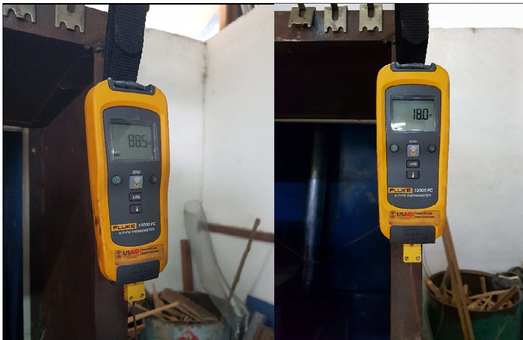
Figura 23. Termómetro digital utilizado para la medición de la temperatura del agua
