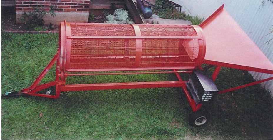
Figura 9. Tromel para tamizar el compost
