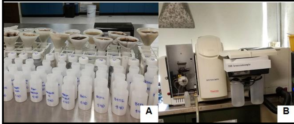
Figura 24. Determinación de micro elementos. A) Disoluciones de las muestras de suelo. B) Espectrofotómetro de absorción atómica.
