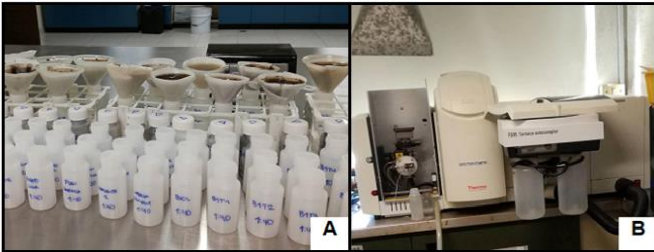
Figura 13. Determinación de microelementos. A) Disoluciones de las muestras de suelo. B) Espectrofotómetro de absorción atómica.
