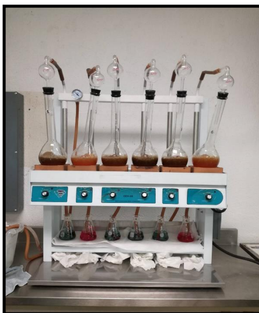
Figura 23. Tren de destilación Kjeldhal.
