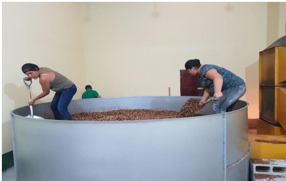
Figura 21A. Volteo de semilla de ramón ( Brosimum alicastrum ) en la tolva de secado.
