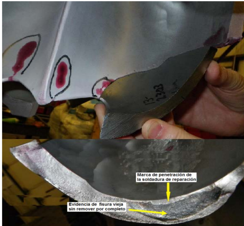
Figura 55. Desprendimiento de cangilón
