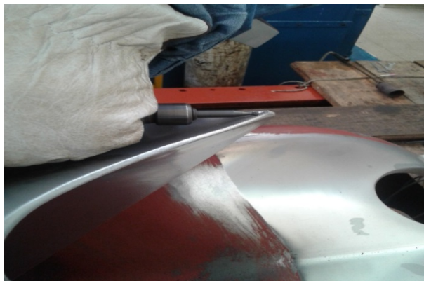
Figura 68. Proceso de fresado y homogeneizado de superficie del rodete Pelton
