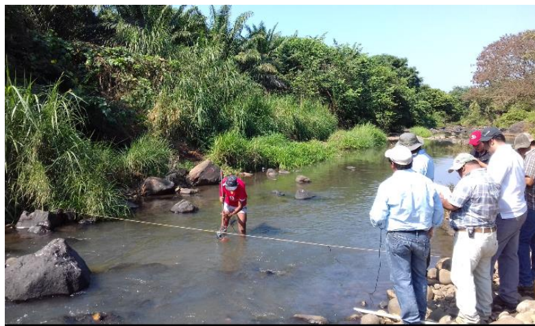
Figura 18. Midiendo la velocidad del caudal con molinete hidrométrico
