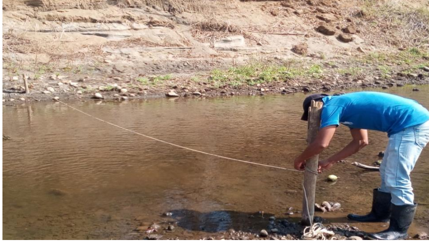
Figura 16. Midiendo el ancho de la fuente hídrica
