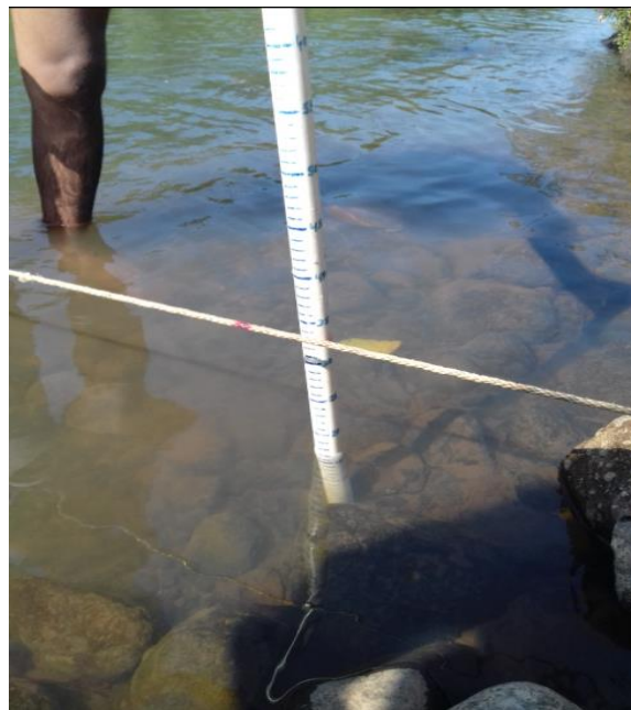
Figura 17. Midiendo la profundidad de cada vertical
