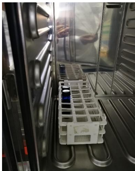
Fotografía 6: Interior de la incubadora en la cual se almacenó la muestra con una temperatura de 36°C.
