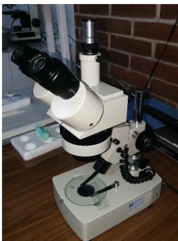
Fotografía 7: Microscopio estereoscópico utilizado para realizar las mediciones de la muestra.
