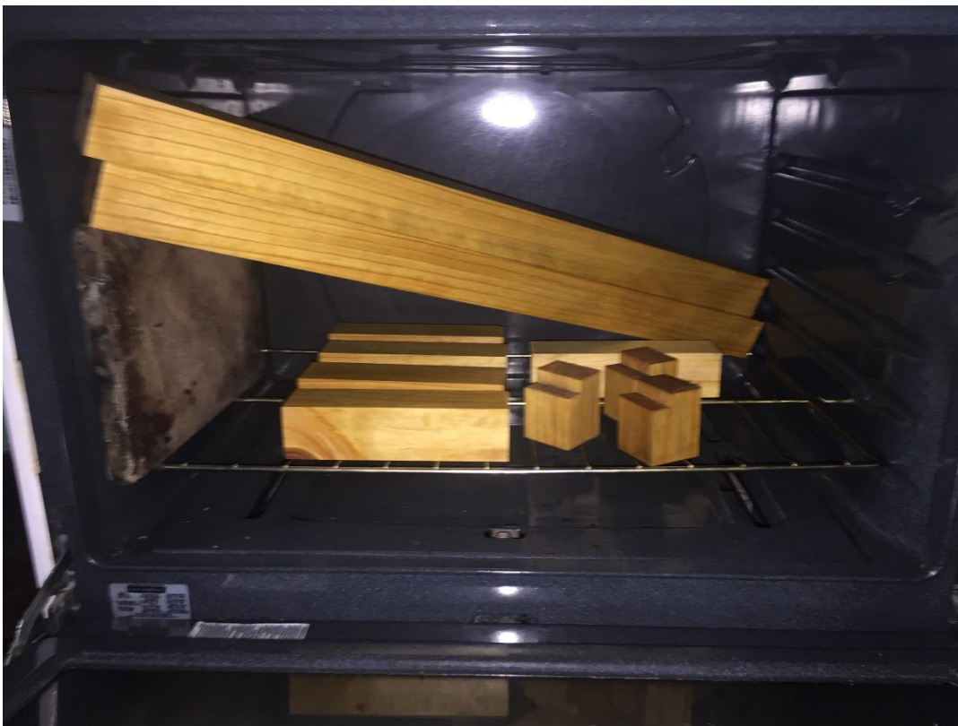
Figura 22. Secado de probetas en horno
