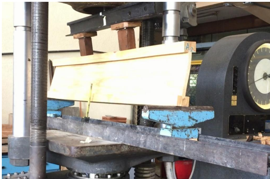
Figura 53. Alabeo seccional en viga A 2
