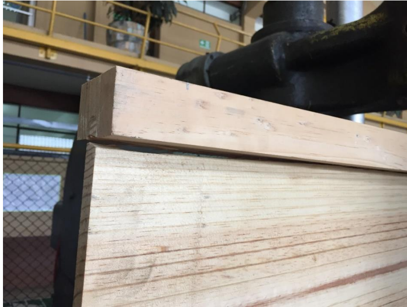
Figura 47. Falla WRS en viga B 1
