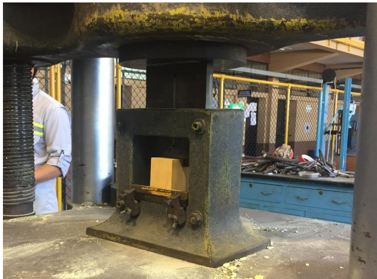
Figura 27. Ensayo de corte perpendicular a la fibra
