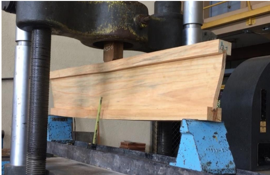
Figura 52. Alabeo seccional en viga A 1
