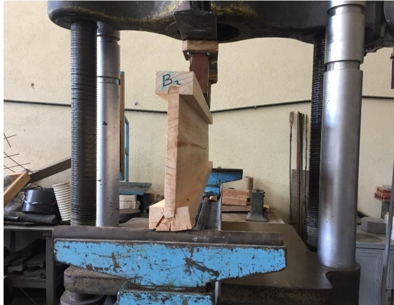
Figura 55. Fractura en apoyo de viga B 2 .
