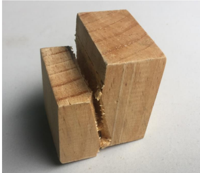
Figura 28. Probeta de ensayo de corte B2, falla por desgarramiento
