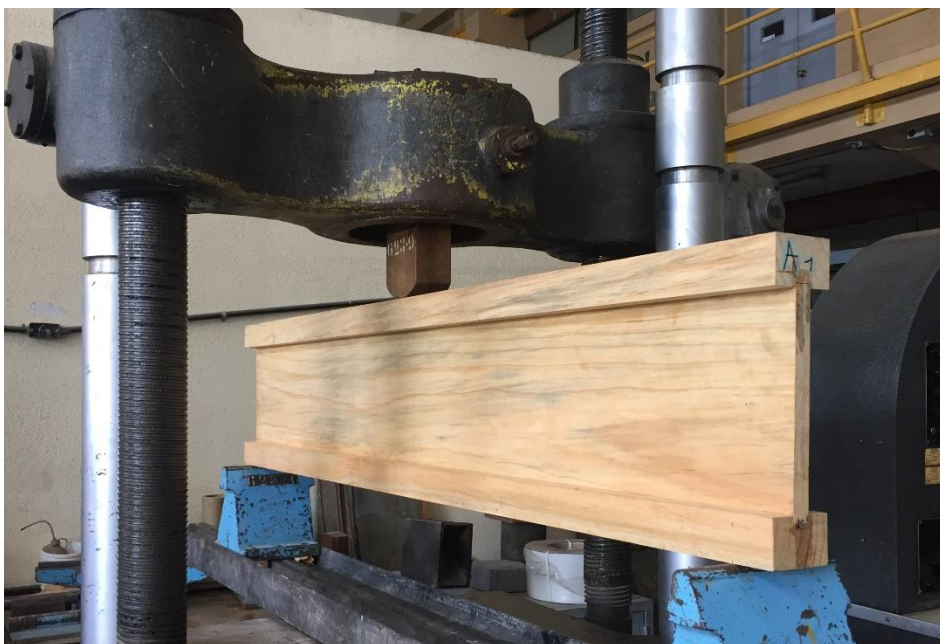
Figura 45. Ensayo a corte en viga tipo I
