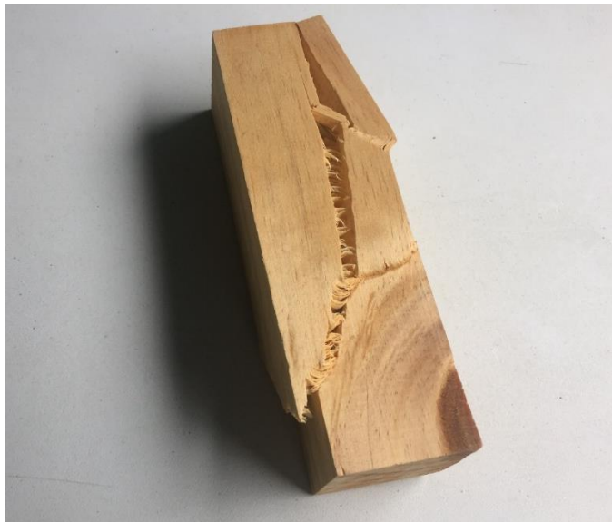
Figura 24. Probeta de compresión A1, falla por corte y rajadura
