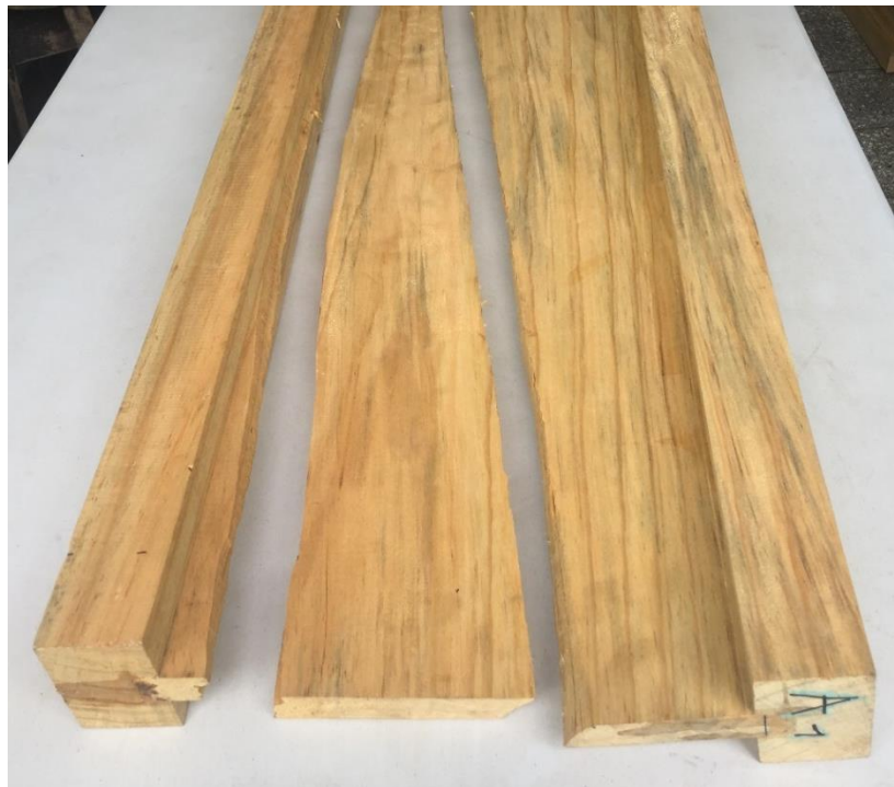
Figura 46. Falla ZJ en viga A_1
