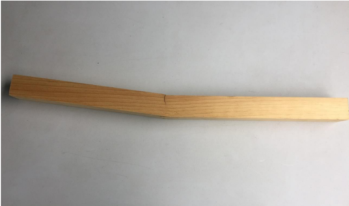
Figura 30. Probeta de ensayo de flexión estática B1, falla por flexión
