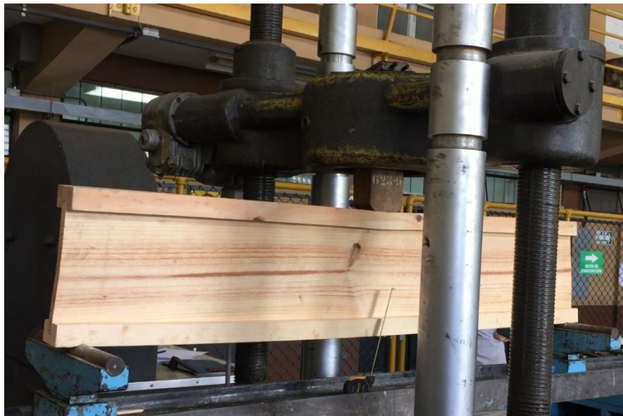
Figura 54. Deformación a flexión viga B_1 .
