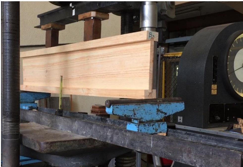
Figura 48. Ensayo a flexión en viga tipo I
