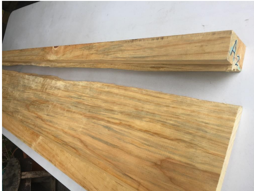
Figura 49. Falla WRS en viga A 2
