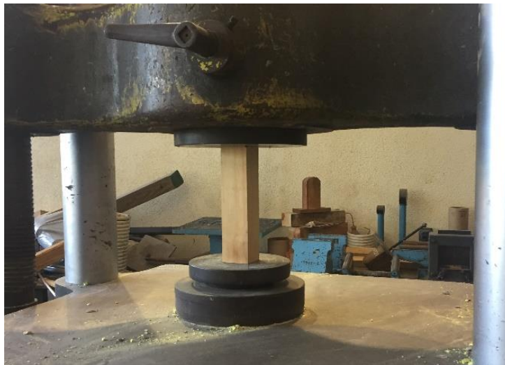
Figura 23. Ensayo de compresión paralelo a la fibra
