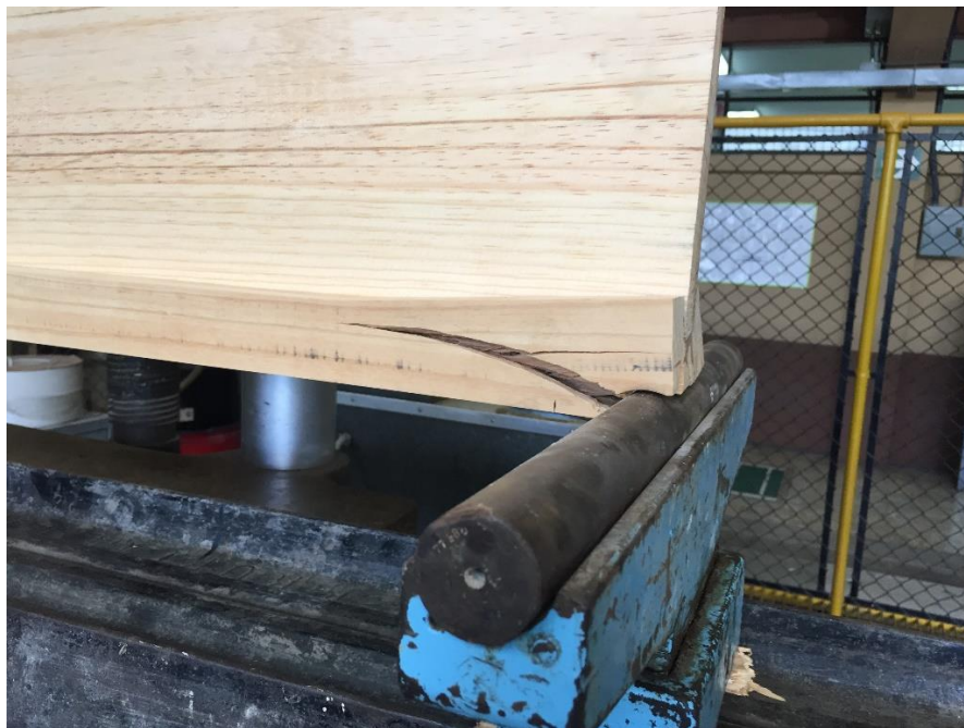
Figura 50. Falla de viga B 2
