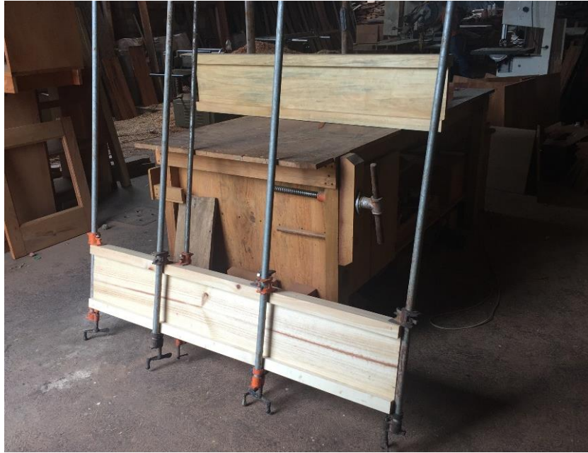
Figura 43. Prensado de vigas
