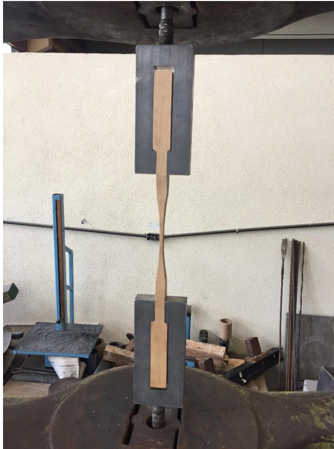
Figura 25. Ensayo de tensión paralelo a la fibra
