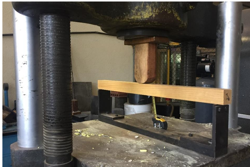
Figura 29. Ensayo de flexión estática
