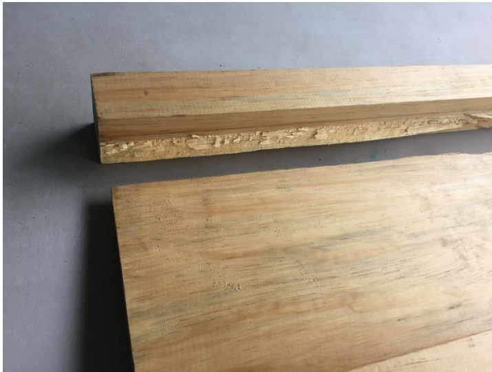
Figura 57. Falla paralela a la unión alma patín de viga A 2
