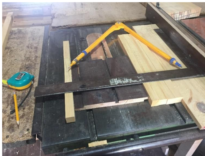
Figura 18. Fabricación de probeta para ensayo de tensión
