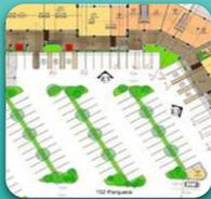
El área de parqueo según el reglamento de dotación y diseño de estacionamientos para el municipio de Guatemala. La dotación en superficies dedicadas a la enseñanza = 1 plaza por cada 30m<sup>2</sup> o fracción.<sup>24</sup>
